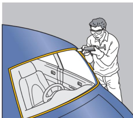
Aplicar **SikaTitan®SOLO** en todo el perímetro del parabrisas o de la carrocería (según la elección), se debe dejar reposar 02 horas (sin airbag) y 06 horas (con airbag). Las temperaturas a aplicar deben estar entre los 5°C y 35°C.
