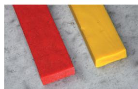
Este sistema activo de sellado de juntas se hincha hacia cualquier agua. Las propiedades flexibles de este material le permiten hincharse en pequeñas grietas o huecos. **SikaSwell® A** se basa en la resina acrílica.
