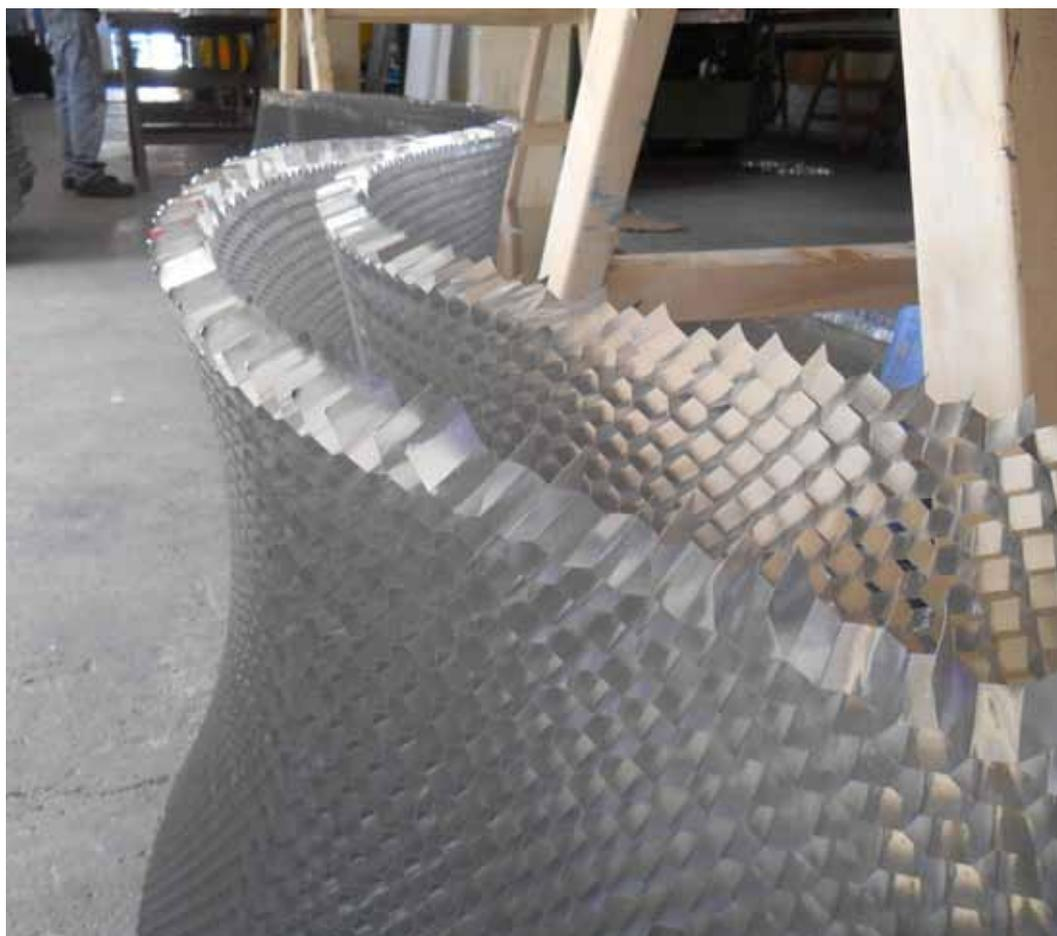
Los paneles de nido de abeja se pueden instalar en grandes dimensiones, tienen una excelente rigidez y planicidad y reducen el peso de la estructura.
