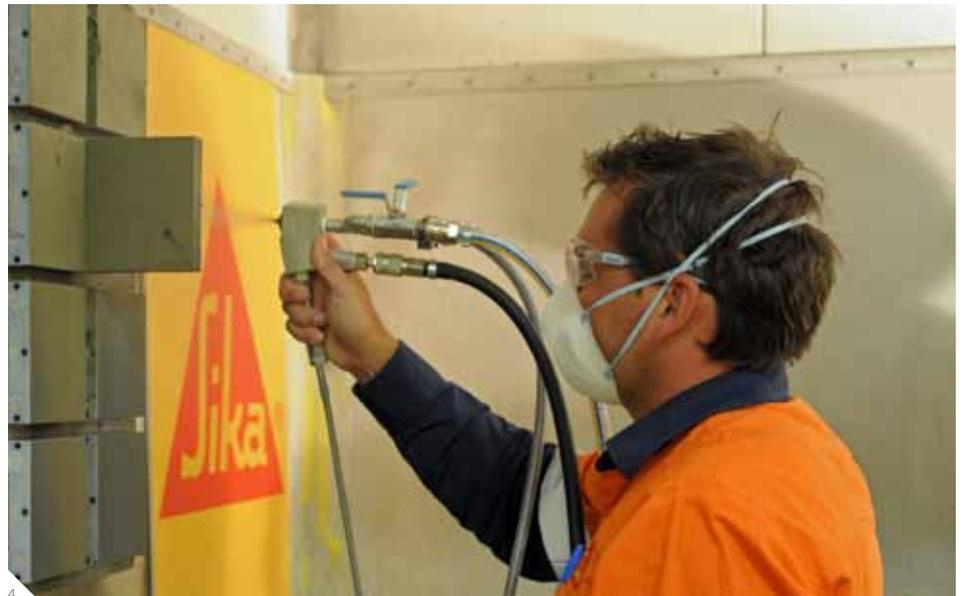
la composición de los componentes del hormigón y su proceso de mezclado en la boquilla de manera realista en miniatura, como el nombre sugiere MiniShot Sika.
