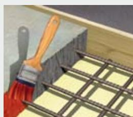
4. El concreto fresco debe ser vaciado antes de 3 horas a 20°C ó 1 hora a 30°C de aplicado el Sikadur 32 Gel.
