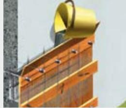
4. Finalizada la colocación, el Sikagrout 212 se debe curar con agua o curador químico.
