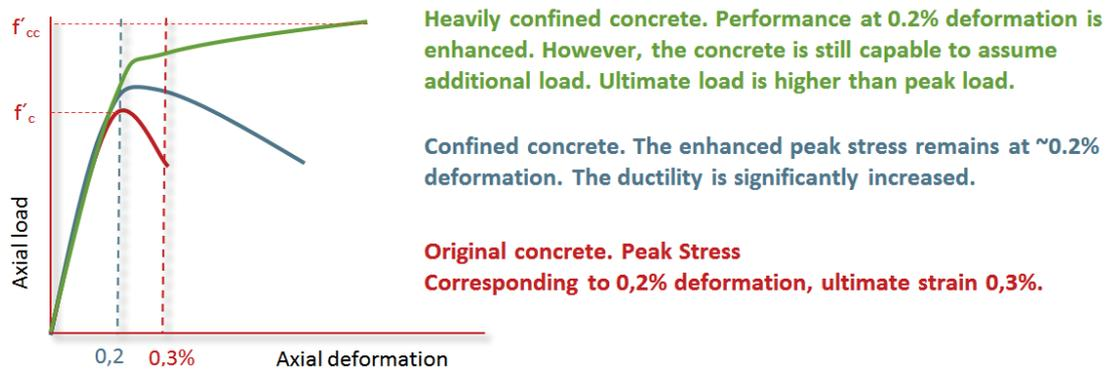
El gráfico muestra un comportamiento casi bilineal con una transición abrupta al alcanzar tensiones próximas a la resistencia del hormigón sin confinar,  $f'_c$ . A partir de este punto la rigidez del material se ve alterada, hasta que el concreto alcanza su resistencia última  $f'_{cc}$  al agotar el encamisado de FRP su máxima deformación  $\epsilon_{fe}$ .
