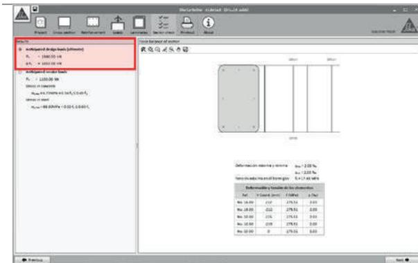
Este apartado permite al usuario conocer los estados tensionales de la sección bajo la combinación de cargas de diseño o de servicio.
