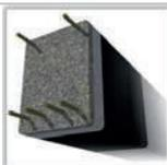
**Refuerzo a cortante de la sección crítica en una viga o columna rectangular.**
