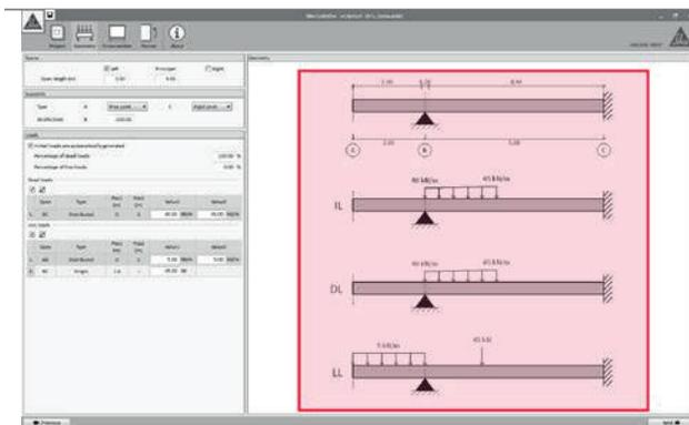
Los esquemas en la pantalla principal muestran la disposición de las cargas definidas por el usuario y el alzado de la viga, repartidos en 4 diagramas:
