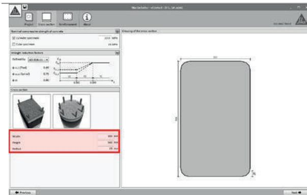
Las dimensiones de la sección son definidas en las casillas situadas bajo los dibujos de selección del tipo de sección.
