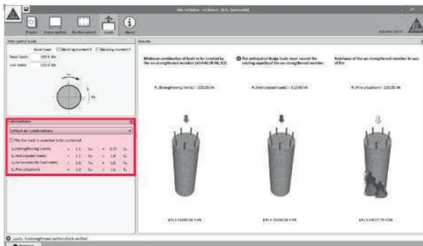
El primer dibujo (izquierda) verifica si el elemento existente (sin reforzar) es capaz de soportar la combinación de cargas mínima (parte superior) indicada en ACI 440.2R-08. La máxima carga admisible se muestra en la zona inferior. Esta condición debe ser cumplida para continuar con el cálculo.
