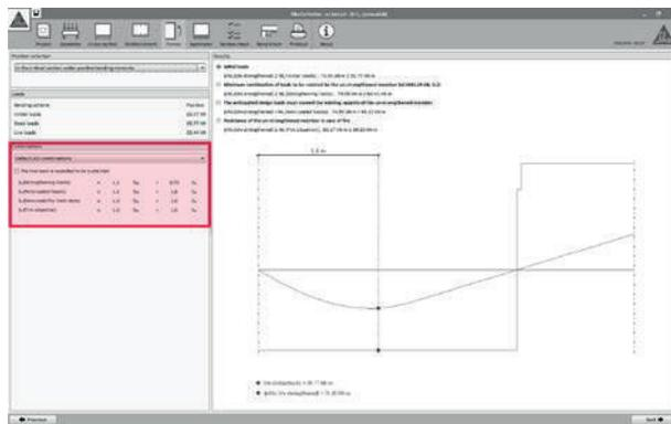
Los factores de combinación de cargas para cada hipótesis se muestran a la izquierda de la pantalla, mostrando por defecto los valores indicados en ACI 318 y ACI 440.2R
