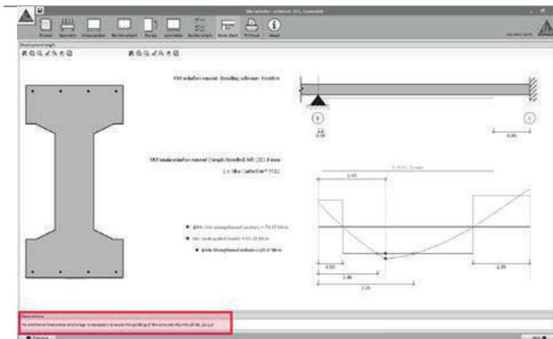
La verificación relativa a la posibilidad de delaminación del extremo del FRP (ACI 440.2R-08), es mostrada en la parte inferior de la pantalla. En el caso en el que el cortante en el extremo del laminado sea superior a 2/3 de la resistencia a cortante del concreto, el FRP deberá anclarse mediante tejidos SikaWrap® o cordones SikaWrap® FX a fin de evitar la rotura del revestimiento de concreto. Consulte al personal de Sika® para mayor información.
