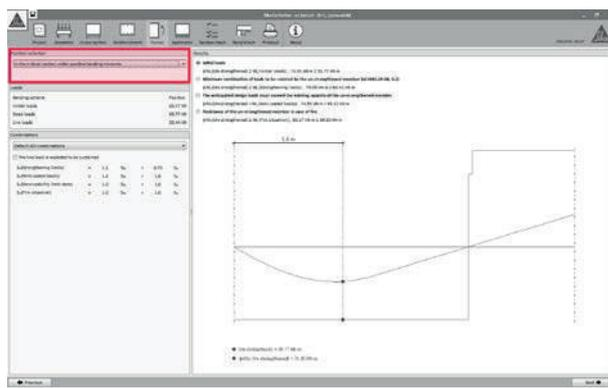
El dimensionado del FRP necesario estará basado en la sección pésima bajo momentos positivos o negativos. La sección pésima es determinada automáticamente por el software.
