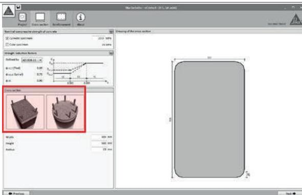
Los dibujos mostrados a la izquierda se emplean para seleccionar la sección transversal del elemento.
