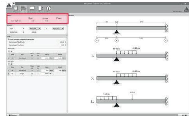
Los cálculos se efectúan para un vano del elemento (vano principal). Sin embargo, es posible definir vanos laterales a efectos de valorar la influencia de las cargas y momentos dispuestos en ellos.
