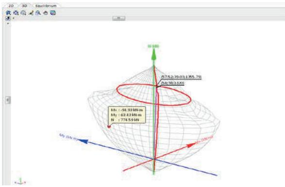
La opción 3D muestra el volumen de interacción para la resistencia última del elemento reforzado, así como la posición correspondiente a la combinación de cargas de diseño.
