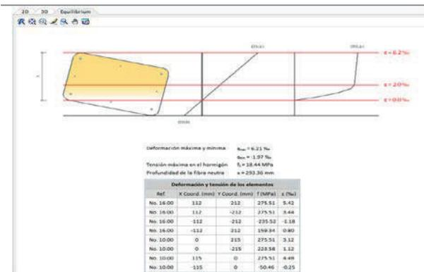
La pestaña denominada “Equilibrio” muestra el diagrama de tensión y deformación de la sección bajo la combinación de cargas de diseño.
