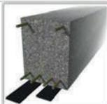
**Refuerzo a flexión de la sección crítica en una viga.**
