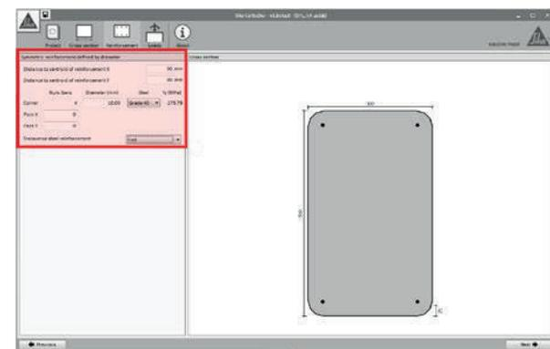
Para secciones rectangulares, el acero de refuerzo es definido a partir de las barras situadas en las esquinas. Adicionalmente, se pueden igualmente determinar los refuerzos de acero longitudinal distribuidos a lo largo de las caras del elemento.
