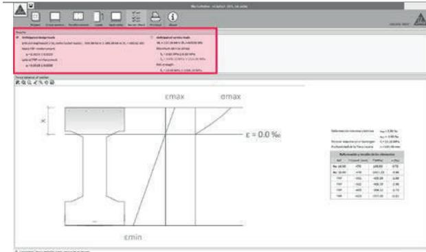
Este apartado permite al usuario conocer los estados tensionales de la sección bajo la combinación de cargas de diseño o de servicio.
