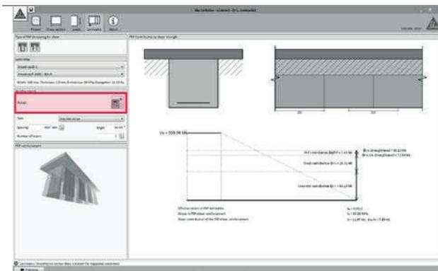
El dimensionado automático (icono con forma de calculadora) tendrá en cuenta la configuración elegida, el tipo de FRP y el espaciado de los laminados (zunchado uniforme o laminados individuales).
