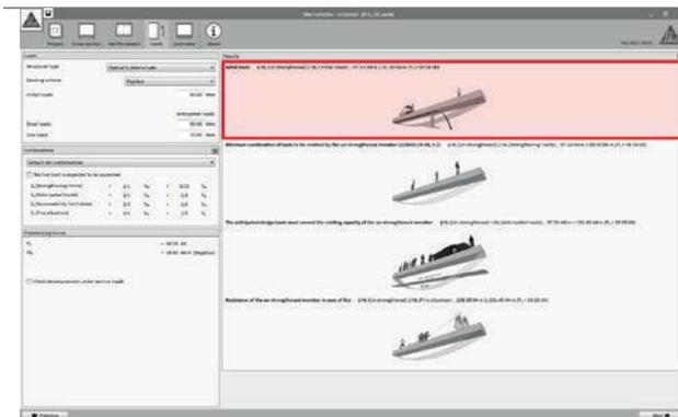
La pantalla principal muestra las comprobaciones preliminares a realizar sobre el elemento sin reforzar respecto a las cargas definidas por el usuario.
