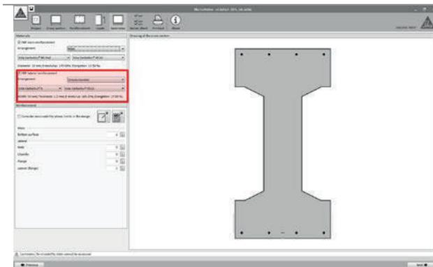
El dimensionamiento del refuerzo mediante FRP puede tomar en consideración los límites de deformación bajo cargas de servicio, debiendo para ello activar la correspondiente opción (de otro modo, el cálculo se efectuará teniendo en cuenta únicamente el estado límite último del elemento).
