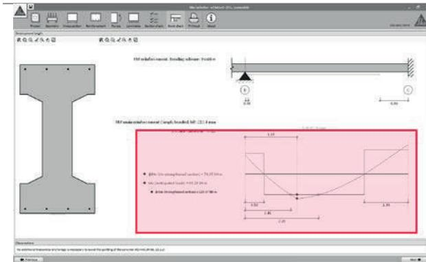
El diagrama de flectores de la pantalla principal mostrará la distribución de momentos correspondientes a las cargas de diseño mayoradas, así como la resistencia inicial del elemento sin reforzar.
