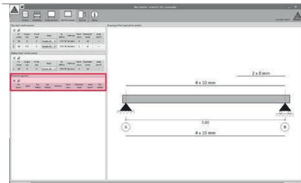
Para aquellos elementos simplemente apoyados y de un único vano, el empleo de acero preesforzado está permitido por el software.
