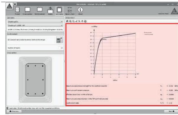
En la pantalla principal se muestra el diagrama de tensión-deformación correspondiente al concreto confinado y sin confinar. La deformación axial se indica en el eje horizontal, y las tensiones en el eje vertical.
