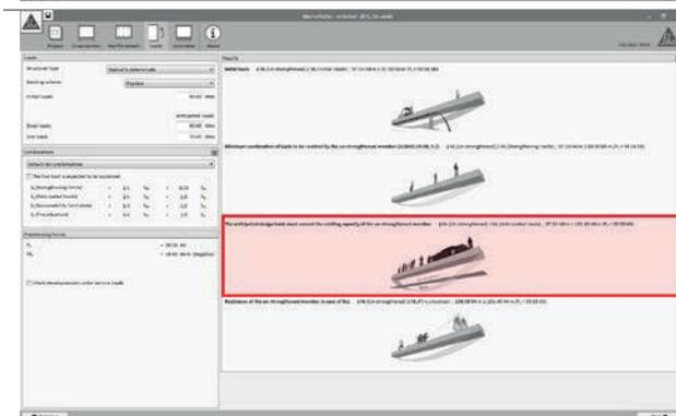
En el tercer diagrama se comprueba que las cargas de diseño previstas exceden la resistencia inicial del elemento sin reforzar. Esta condición deberá cumplirse para continuar con el cálculo.
