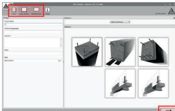
Independientemente del tipo de refuerzo seleccionado, el proceso de cálculo está dividido en fases sucesivas, las cuales se indican en los iconos mostrados en la zona superior de la pantalla. El tipo y cantidad de etapas varía en función del refuerzo seleccionado y los datos introducidos por el usuario.
