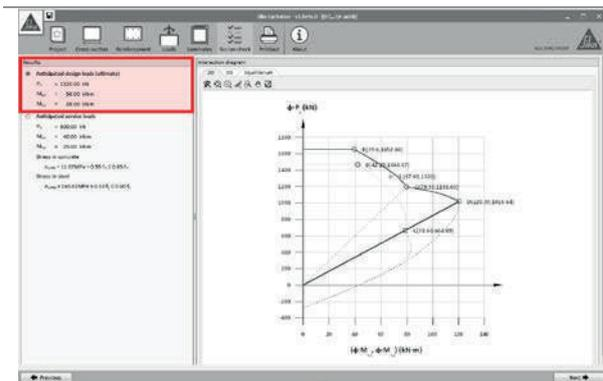
En el caso de que axiales y momentos actúen simultáneamente (excentricidad mayor que 0.1h), la información concerniente al comportamiento del elemento bajo las cargas de diseño será sustituida por un diagrama de interacción.
