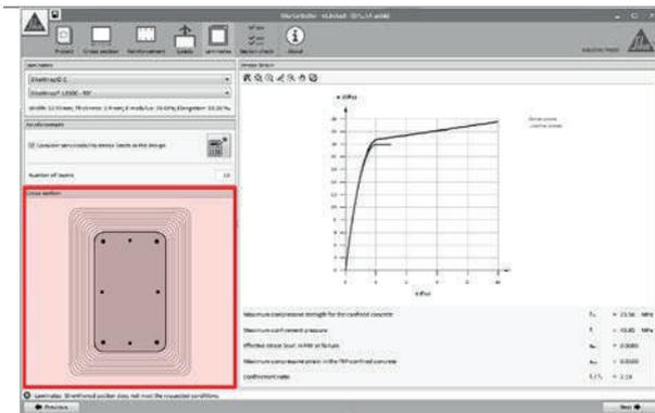
El dibujo esquemático a la izquierda muestra las capas necesarias del laminado SikaWrap® seleccionado.
