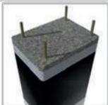
**Refuerzo de columnas mediante confinamiento con FRP.**
