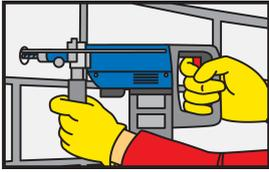
Perfore con un taladro eléctrico en el diámetro y profundidad requerida. El diámetro de la perforación debe ser acorde al diámetro del perno.
