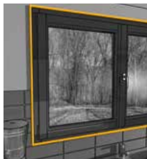
Sellado perimetral de puertas, ventanas y carpintería.
