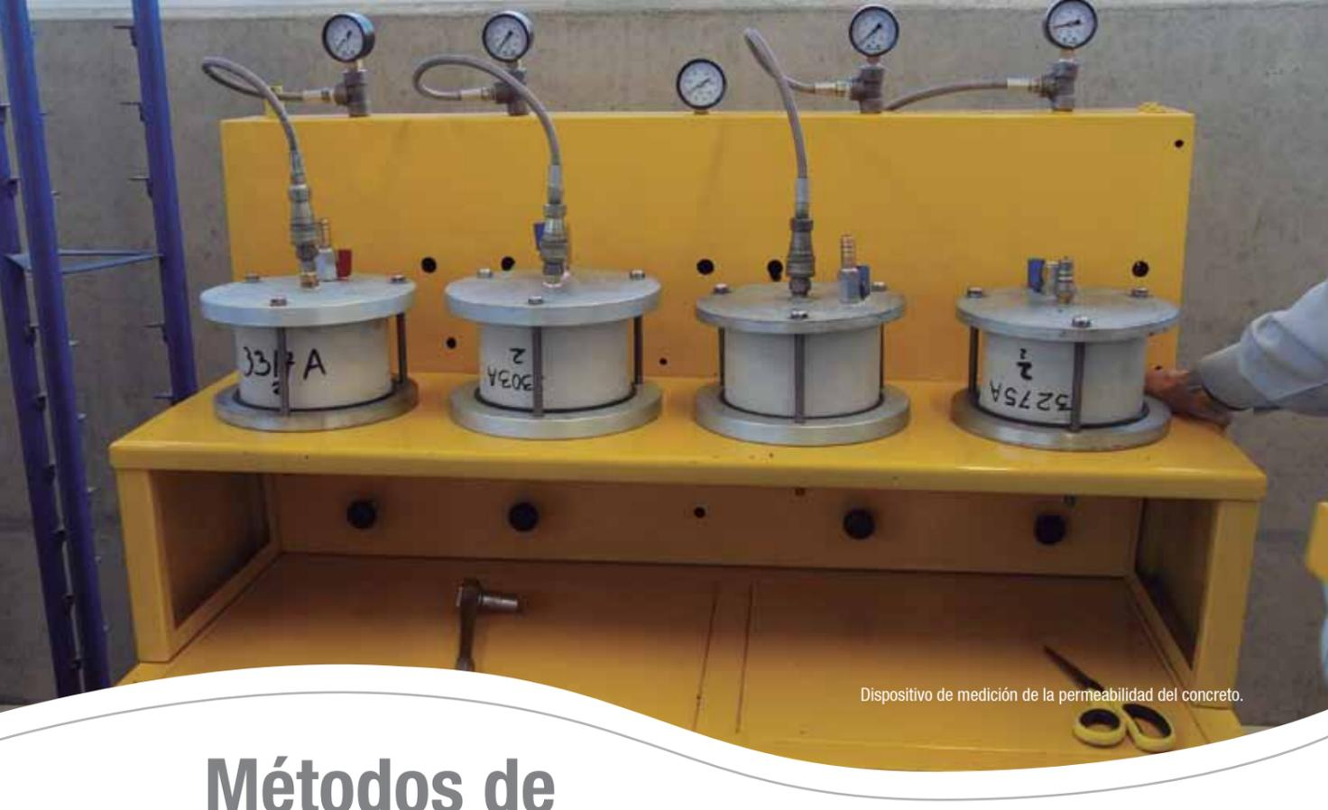
Dispositivo de medición de la permeabilidad del concreto.
