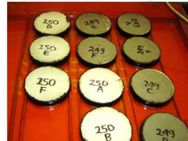
Figura 13. Especímenes de mortero semisumergido con y sin Sika 1 al cabo de 4 horas de absorción capilar.
