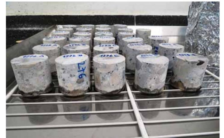
Figura 19. Ensayo de absorción capilar de concreto de acuerdo con la norma SIA 262-Anexo A.
