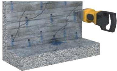
1. Realice agujeros para los packers mecánicos a través del componente de elemento filtrante a una distancia de 30 - 50 cm, como se muestra en la imagen.
