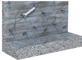
2. Instale los packers mecánicos. Ajuste los packers mecánicos para que puedan resistir las presiones máximas de inyección.
