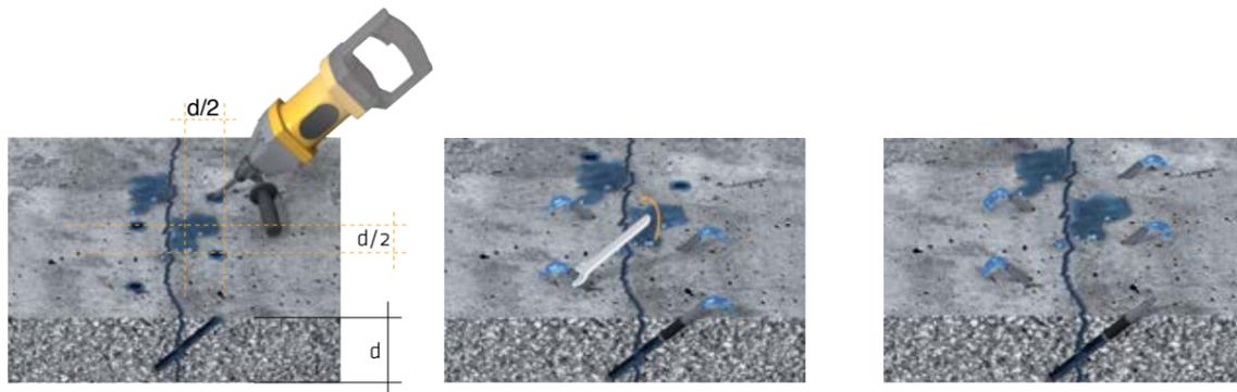
1. Realice agujeros para el packer alternador en un ángulo de 45° respecto de la superficie de concreto, como se muestra en la imagen.  $\varnothing$  de agujero perforado =  $\varnothing$  de packer + 2 mm
