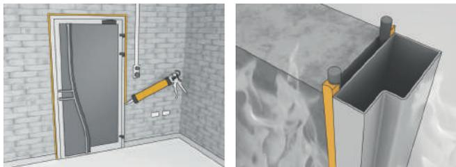
**Sikasil®-670 Fire** es un sellante elástico a base de silicona para juntas con retardo al fuego, de 1 componente, cura por humedad, de bajo módulo de elasticidad.
