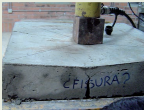
Ensayo EFNARC para determinar la absorción de energía en concreto lanzado.
