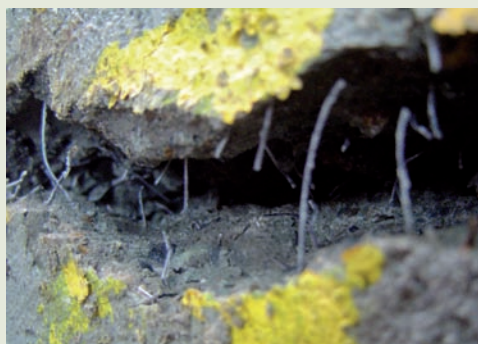
Interior de la falla, nótese las fibras perpendiculares al plano de falla cuyo anclaje se perdió.
