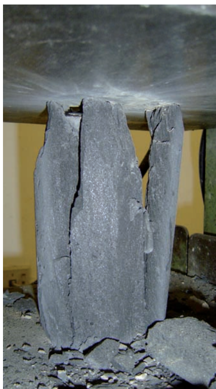
Falla de concreto de ultra alta resistencia, sin fibras
