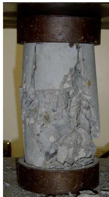
Falla de concreto de ultra alta resistencia, con fibras
