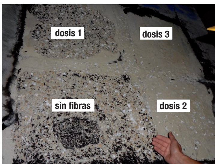
Prueba de resistencia al fuego de paneles de concreto reforzado con fibras [6]
