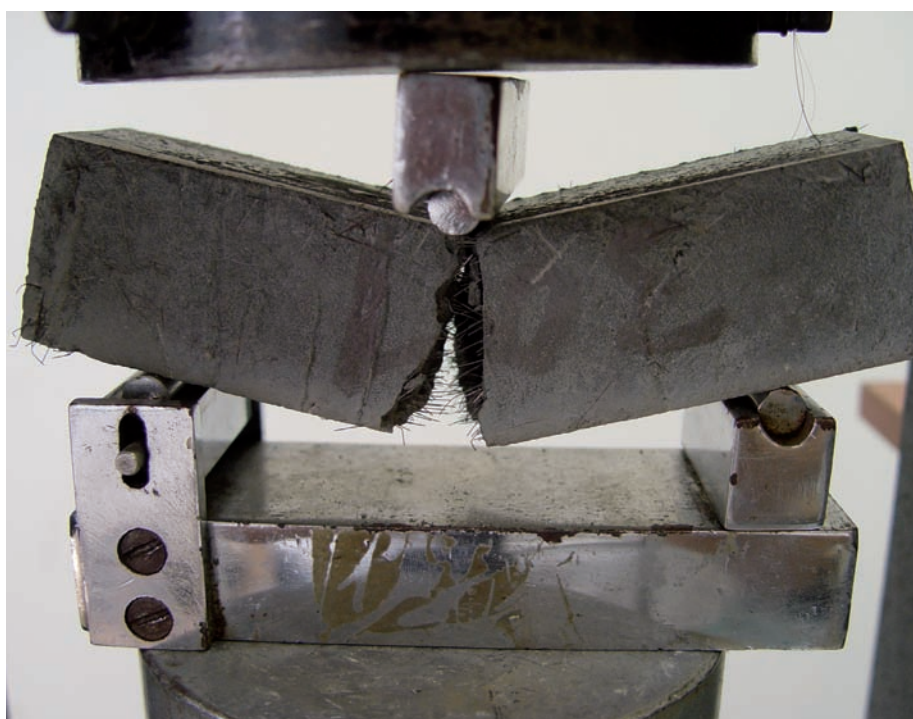
Prueba a la flexión de concreto con fibras para un Módulo de Ruptura de 200 kg/cm 2 .
