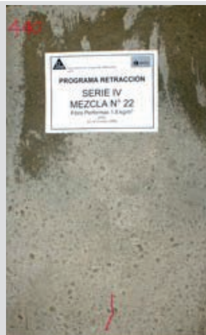
Fig. 3 - Concreto 4000 psi a las 24 hrs con Sika® Fiber PE, expuesto a viento de 2 m/s
