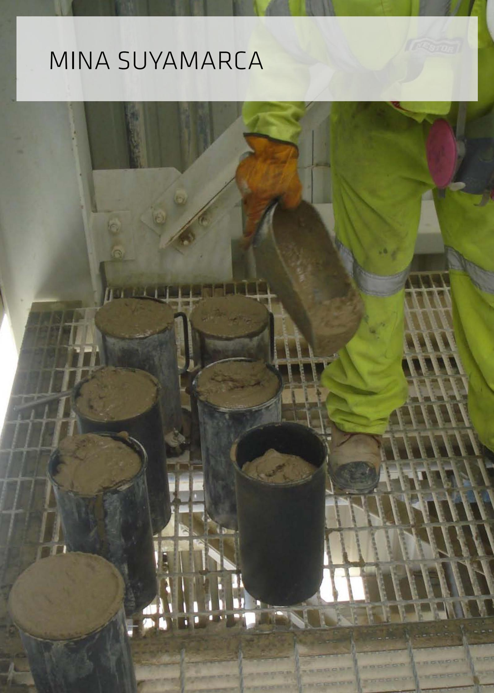
La planta de relleno Paste Fill de la **MINA SUYAMARCA**, provee una pasta compuesta de relave, cemento, agua y aditivos. La finalidad es rellenar las labores ya explotadas, haciéndolas estables para poder seguir con la explotación en otras áreas sin problemas de derrumbes, dando seguridad al personal y equipos que trabajan dentro del túnel.
