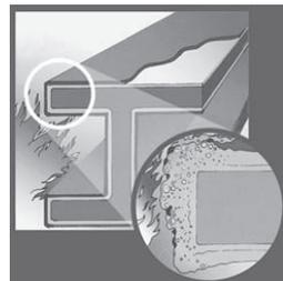
Si bien el acero no se quema, puede perder su fortaleza estructural tan sólo unos minutos después de verse expuesto a un gran calor. El resultado es que la estabilidad estática no se puede seguir garantizando y el edificio se derrumba.
