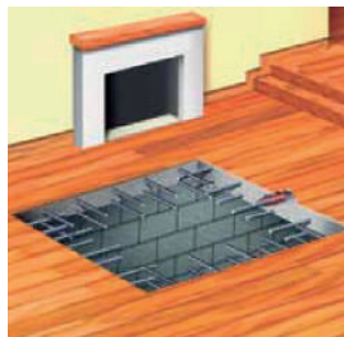
Recrecimiento de losas, conexiones de muros con losas.
