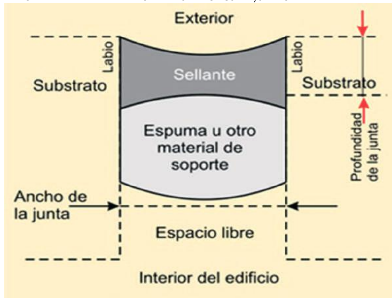
IMAGEN N° 2 - DETALLE DEL SELLADO ELÁSTICO EN JUNTAS
